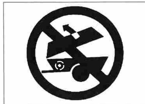
No hacer funcionar el compresor con la carrocería o parte de ella abierta.
