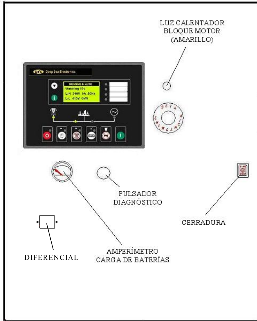
Imagen 8 - Cuadro de Control de Placa de Control DeepSea
